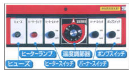
操作パネル部
