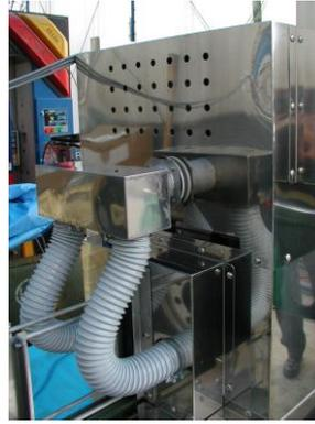
強力ブローを採用することでトレーの水滴を一蹴します。
