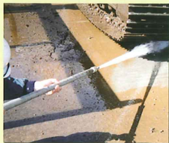
低圧ハンドガン 土砂を大水量で一気に流します! 残った土砂もこれで一網打尽!!
