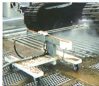
シュー面洗浄機 シュー表面の頑固な土を高圧の 直射噴流で自動洗浄します!!
